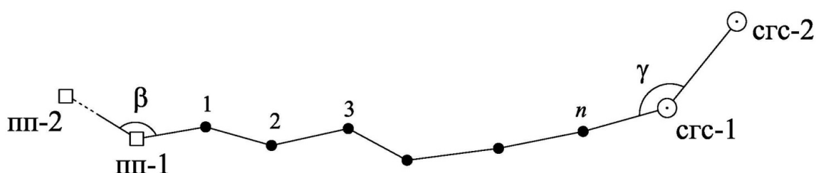
Рис. 1. Схема одиночного разомкнутого хода полигонометрии
