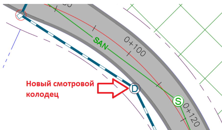
Рис. 1.13. Вновь созданный смотровой колодец и соединенные с ним трубы измененного размера
