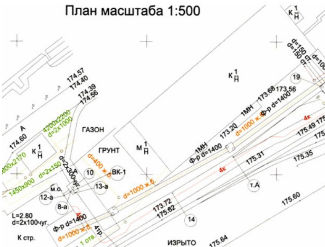
Рис. 3.1. Фрагмент исполнительной схемы подземных коммуникаций
