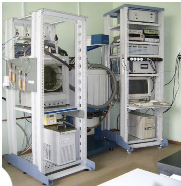
Рис. 3. Общий вид эталонного калориметра «В-06 АК»
