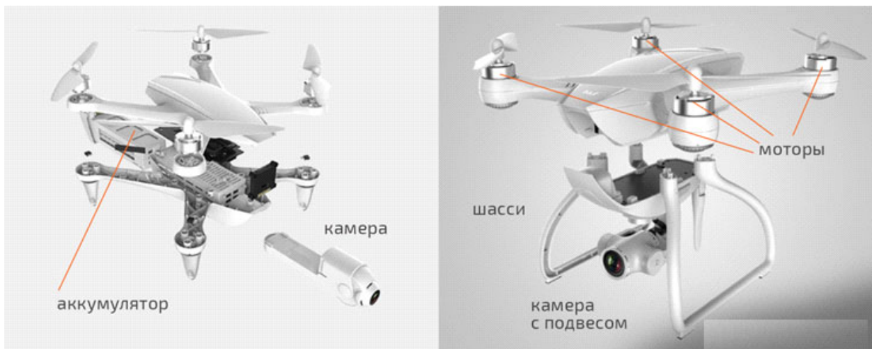
Рис. 4.6. Устройство БПЛА вертолетного типа, модель DJI Phantom 4 [9]
