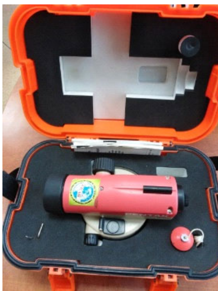
Рис. 2.2. Комплектация нивелира Pentax AP-128
