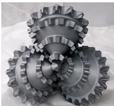
Рис. 2.14. Зубчатое шарошечное долото
