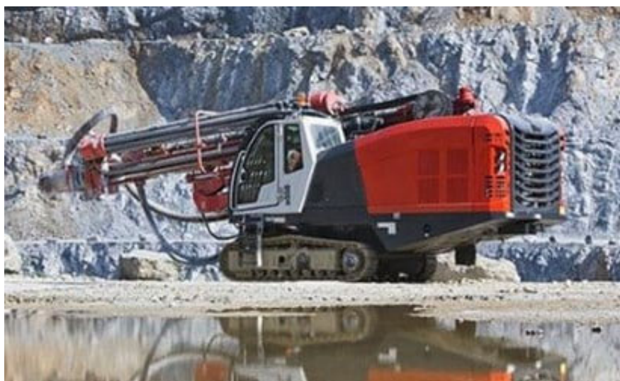
Рис. 2.6. Буровой станок Leopard DI550 (Sandvik)
