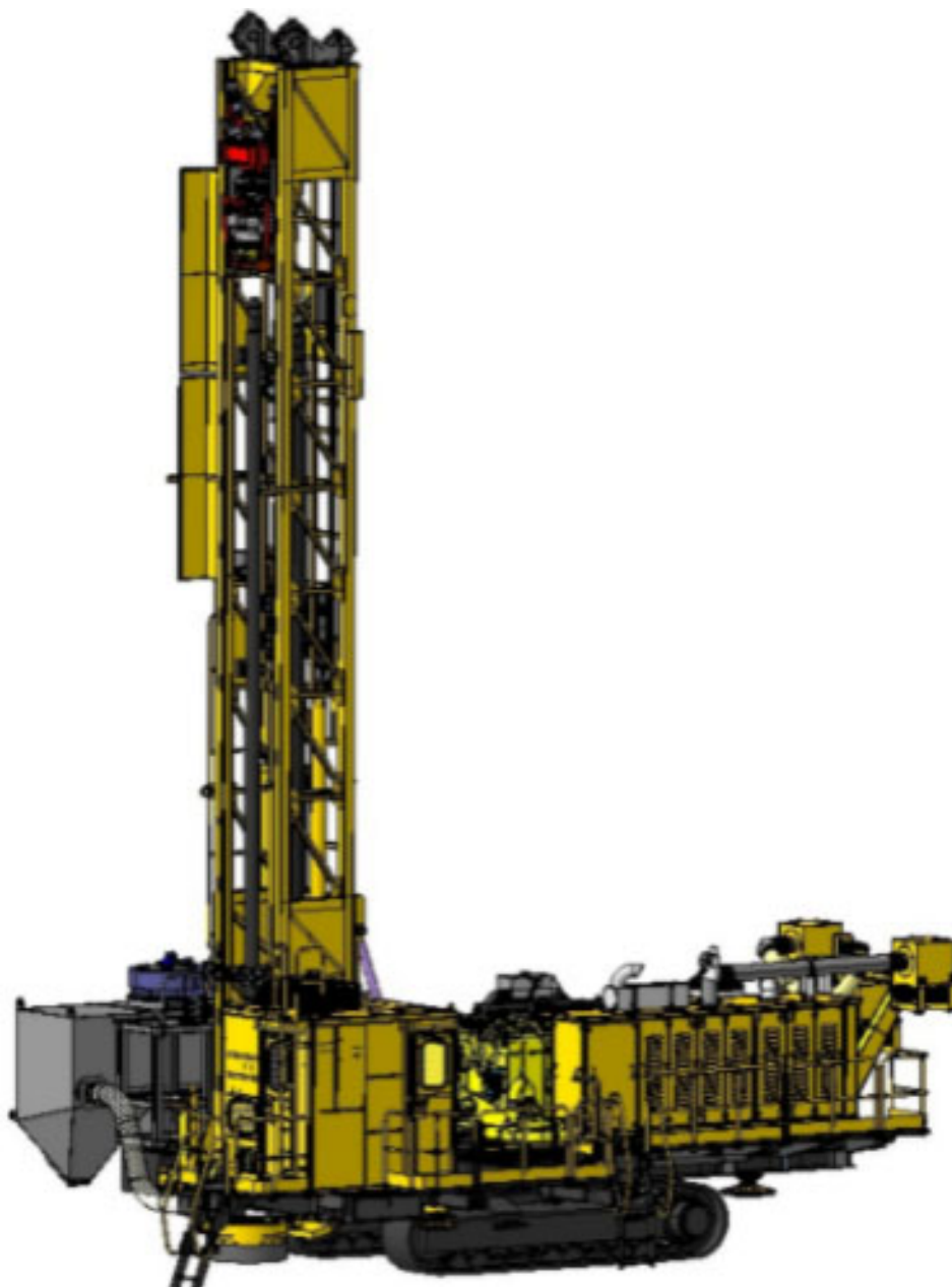
Рис. 2.5. Буровой станок СБШ-160/230 ДС/ДМ (Рудгормаш)
