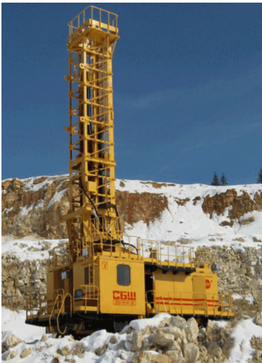
Рис. 2.4. Буровой станок СБШ-250 МНА-32 (Рудгормаш)
