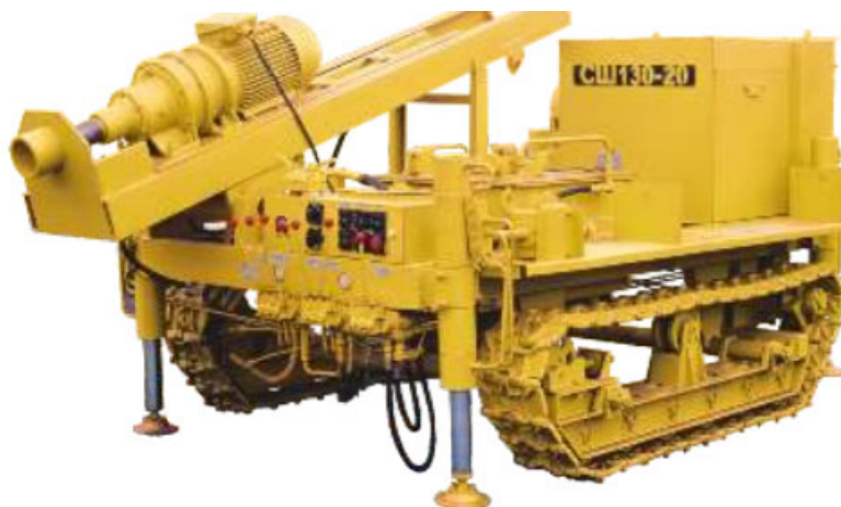
Рис. 2.1. Станок СШ-130 (Кыштымское машиностроительное объединение)
