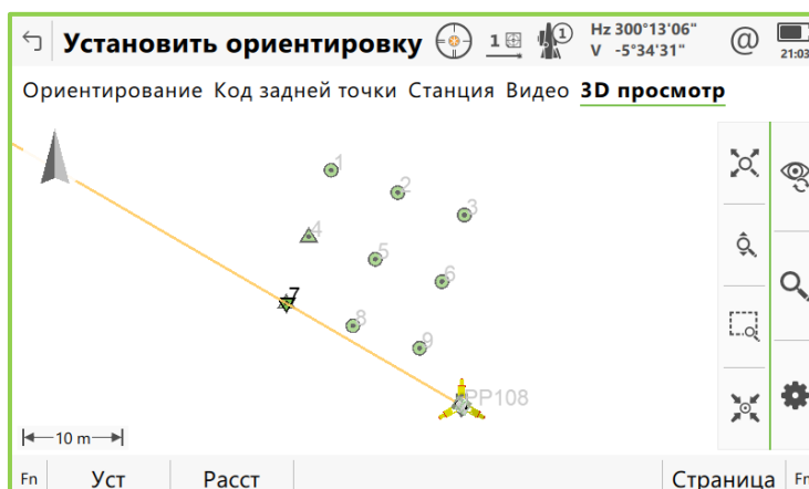
Рис. 57. Установка ориентирования, вкладка «3D просмотр»
