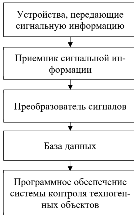
Рис. 1. Принцип работы автоматизированной системы мониторинга
