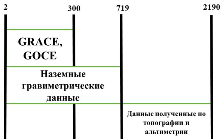
Рис. 3.19. Схема комбинации различных типов данных при создании модели XGM2019e_2159: 2, 300, 719, 2190 – максимальные степени учитываемых гармонических коэффициентов геопотенциала
