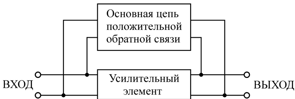
Рис. 8.5. Положительная обратная связь в генераторах импульсов
