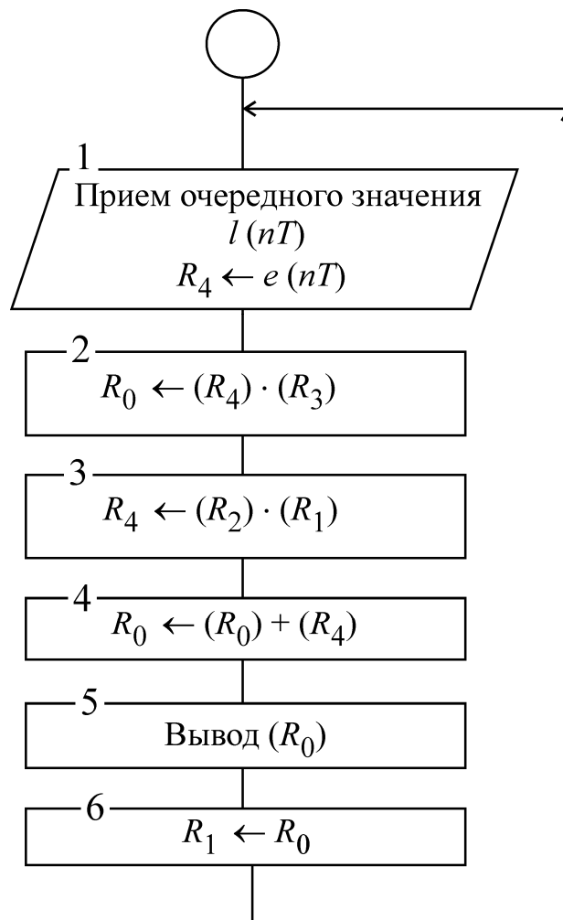
Рис. 10.2. Схема алгоритма при цифровом методе анализа процесса в RC -цепи
