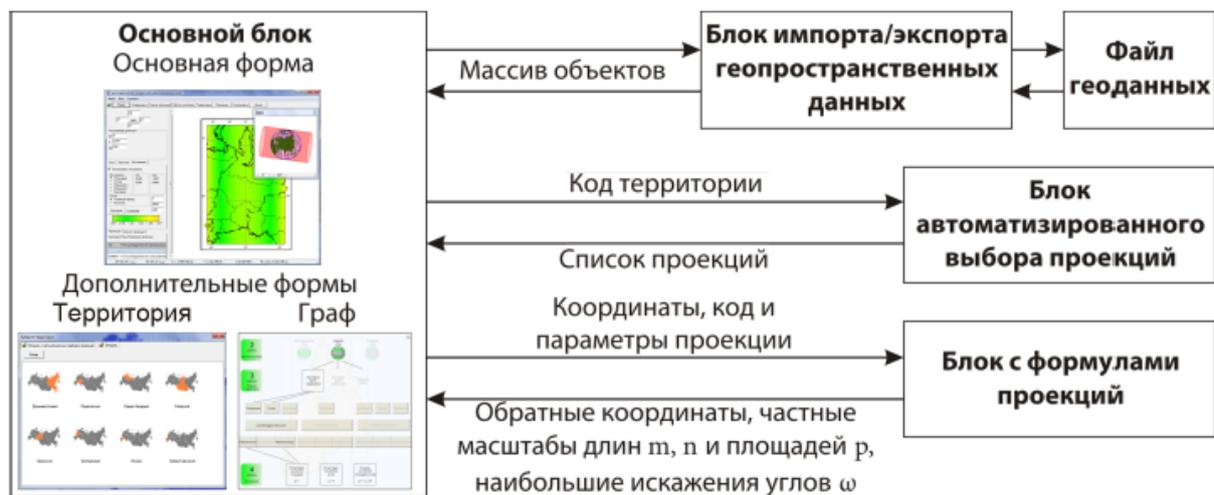
Рис. 14. Схема работы специализированного комплекса по выбору проекций
