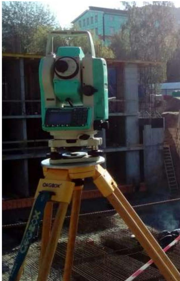
Рисунок 13 – Электронный тахеометр Nikon NPL-332
