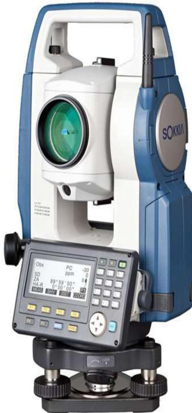
Рисунок 13 – Тахеометр Sokkia CX-102
