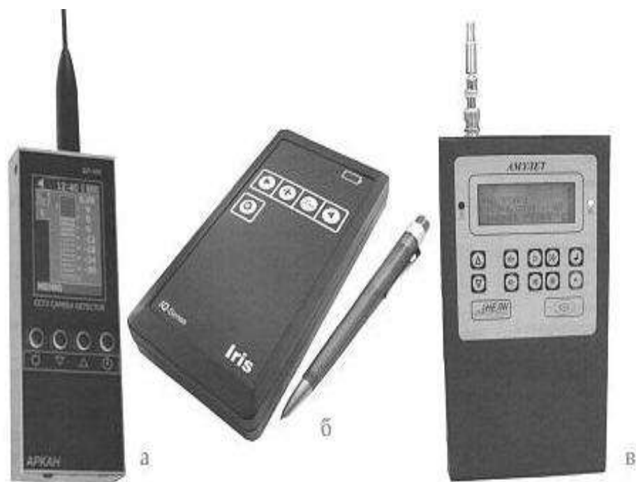
Рисунок 8—Детекторы видеокамер: а) SEL SP-101 «Аркан»; б) «Айрис»; в) «Амулет»
