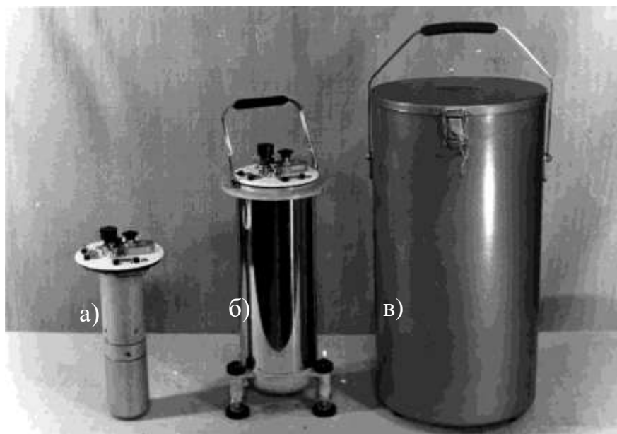
Рис. 2.1. Гравиметр: а) внутренняя часть прибора; б) общий вид прибора; в) транспортировочный футляр цилиндрической формы, изготовленный из жести
