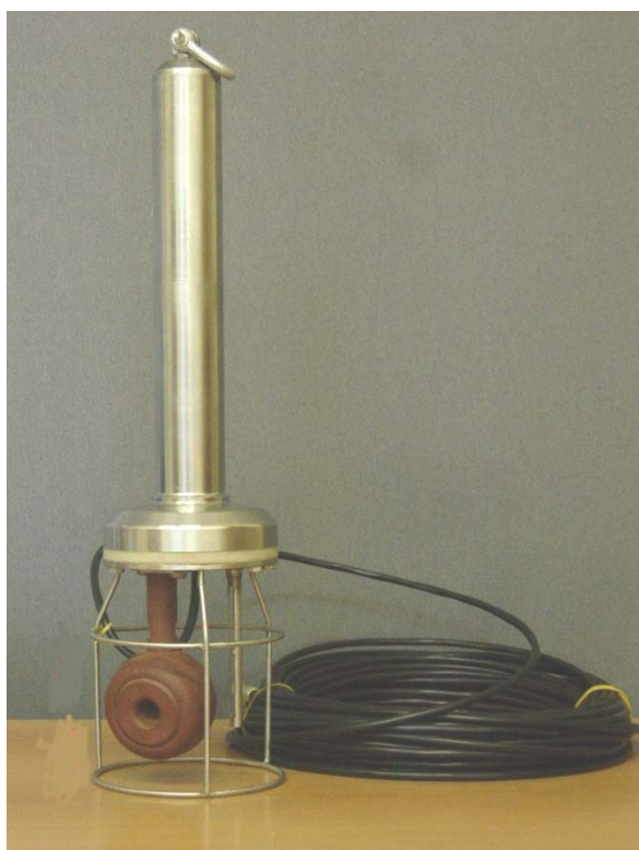
Рис. 2.13. Гидрологический мини-зонд фирмы НПО «Тайфун» (Россия)
