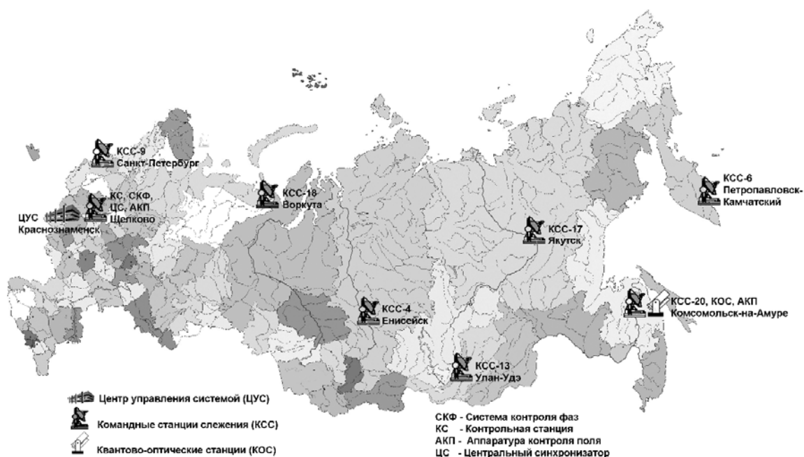
Рис. 4.8. Наземный комплекс управления системой ГЛОНАСС [6]
