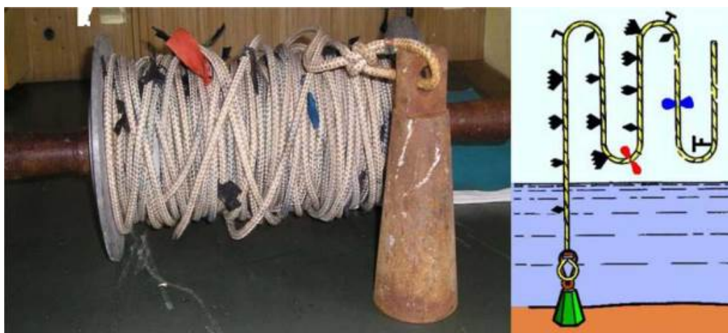
Рис. 1.5. Ручной лот 2 (Режим доступа: http://poznayka.org/s62734t1.html )
