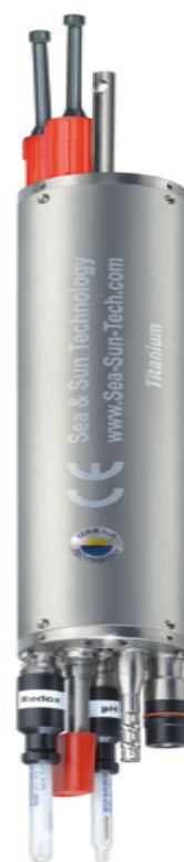
Рис. 2.14. Гидрологический зонд фирмы Sea & Sun Marine Tech (Германия)
