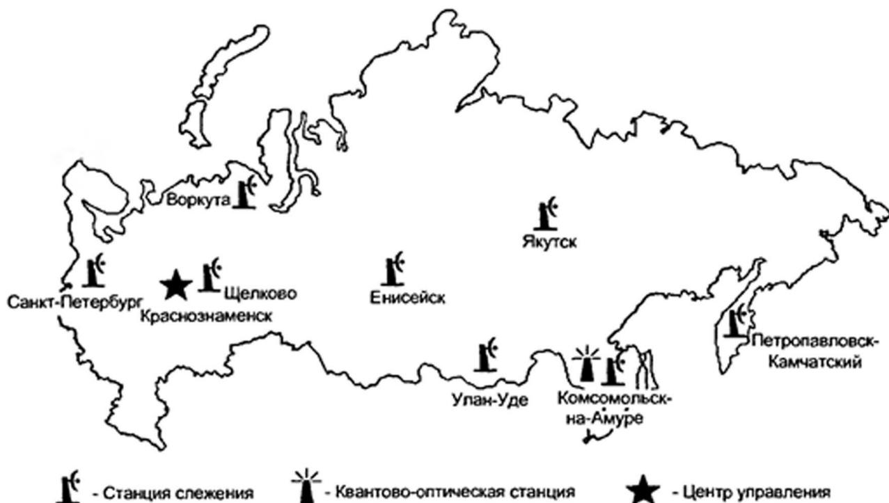
Рис. 12. Расположение наземных станций слежения СНС ГЛОНАСС
