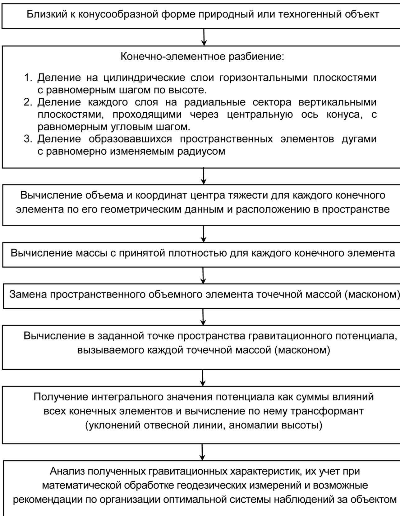
Рис. 26. Общая схема алгоритма аппроксимации гравитационного влияния конуса как сумма влияний конечных элементов – вытянутых параллелепипедов [23]
