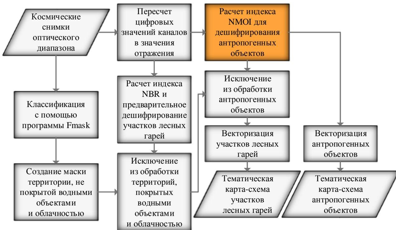
Рис. 37. Усовершенствованный алгоритм обнаружения и картографирования объектов природного и антропогенного характера
