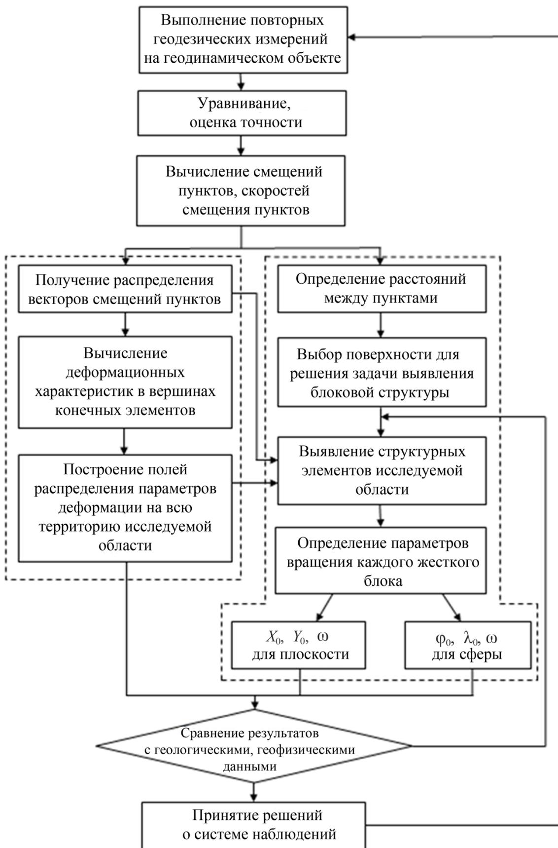
Рис. 51. Схема разработанной методики изучения вращательных движений земной поверхности по результатам геодезических измерений
