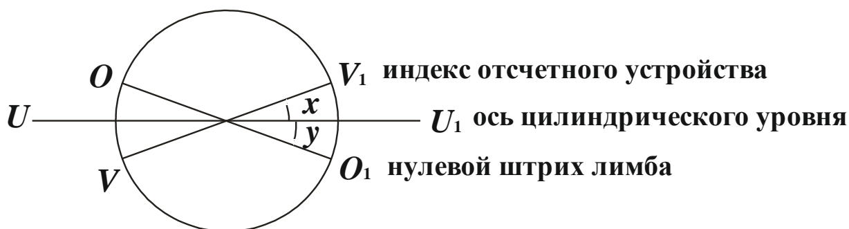
Рис. 21. Место нуля вертикального круга
