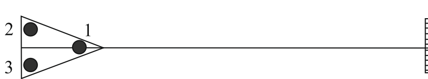
Схема расположения подъемных винтов нивелира
