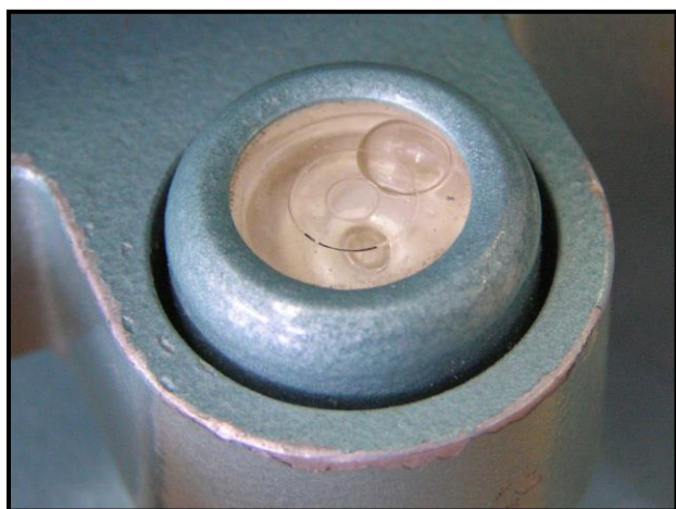
Рис. 34. Общий вид круглого уровня; положение пузырька уровня при начале выполнения поверки
