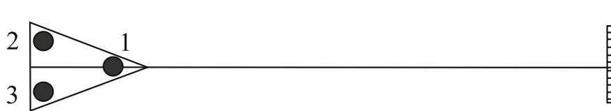
Схема положения пузырька круглого уровня при исследовании компенсатора
