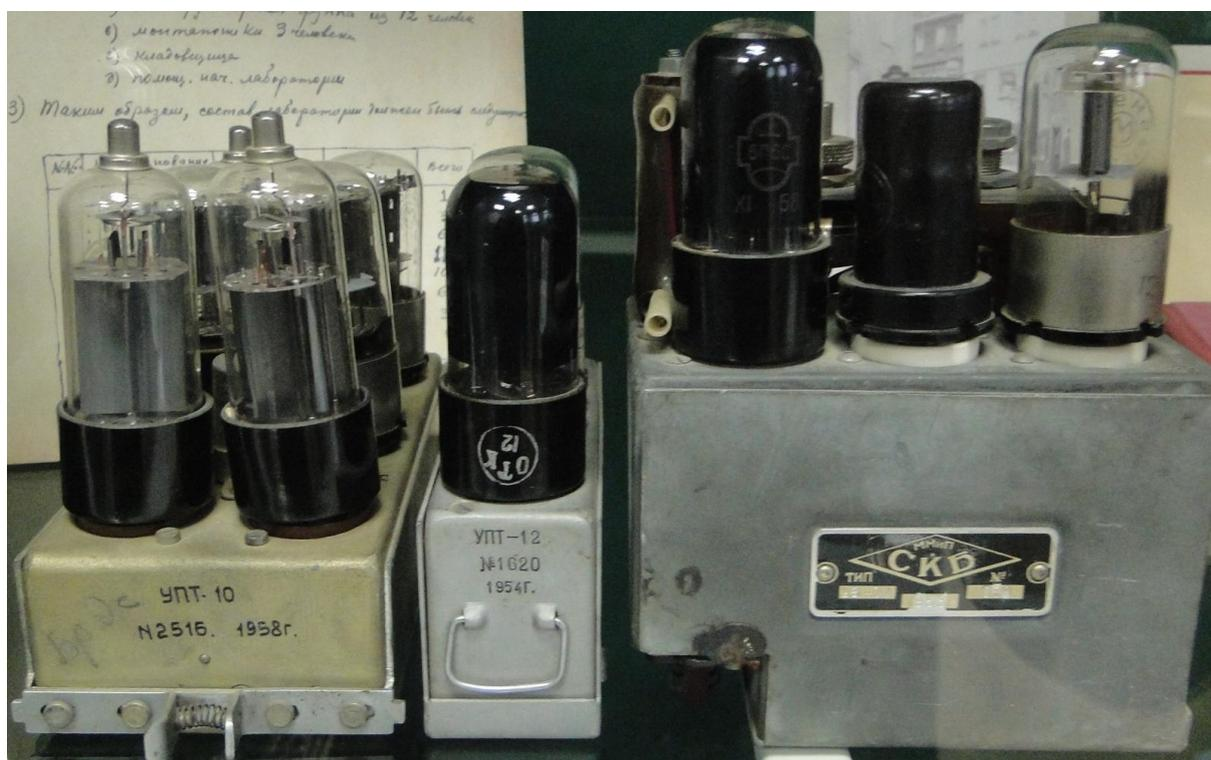
Рис. 7. Блоки процессора ЭВМ «Стрела»
