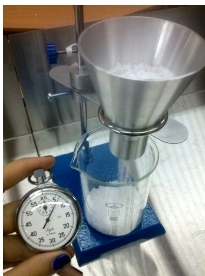
Рис. 5.2. Прохождение полимера через воронку
