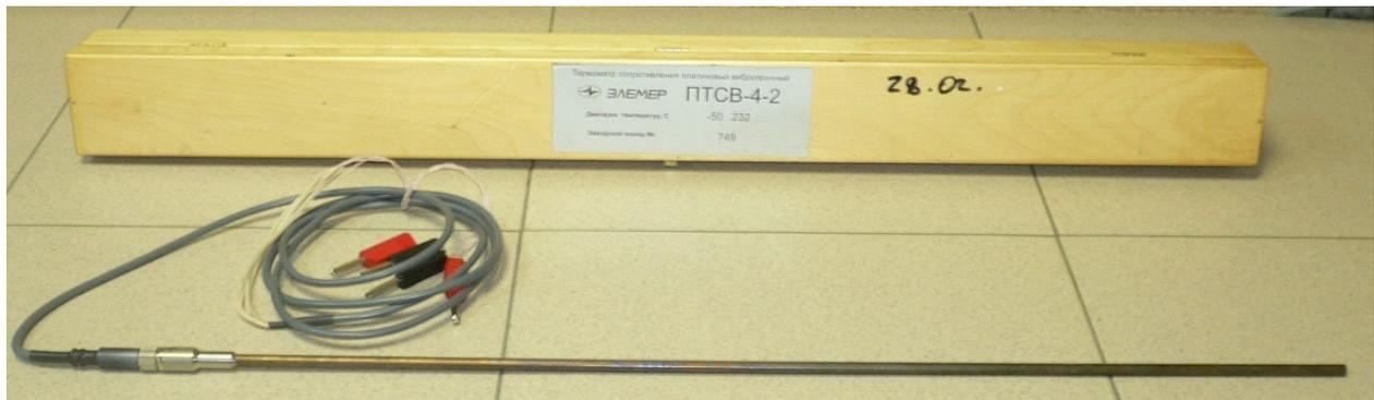
Рис. 6. Эталонный термодатчик сопротивления 2-го разряда
