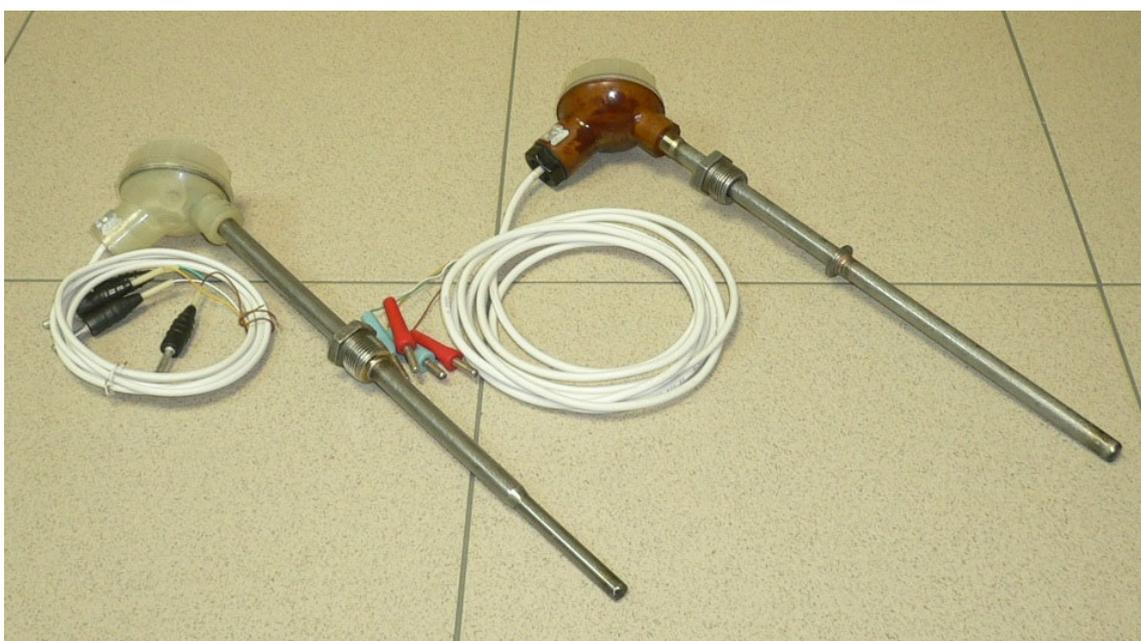
Рис. 7. Обычные термодатчики сопротивления
