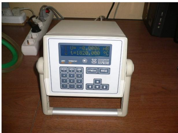
Рис. 11. Прецизионный преобразователь сигналов «ТЕРКОН»
