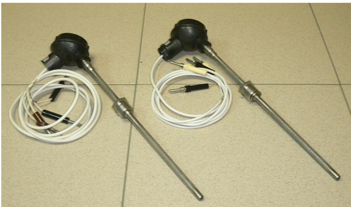
Рис. 9. Термоэлектрические датчики температуры
