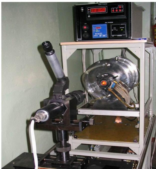
Рис. 26. Калибровка эталонного пирометра по высокотемпературной модели АЧТ, входящей в состав первичного эталона температуры
