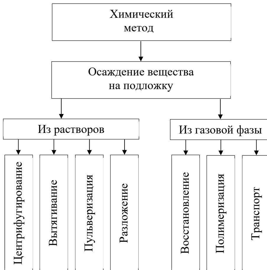
Рис. 2.1. Химические методы получения пленок [6]
