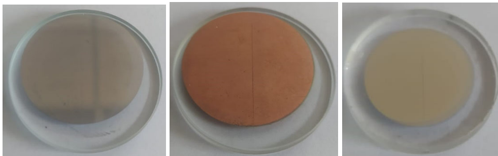
Рис. 4.4. Образцы тонких пленок различной толщины на стеклянных подложках, полученные методом термического испарения в вакууме
