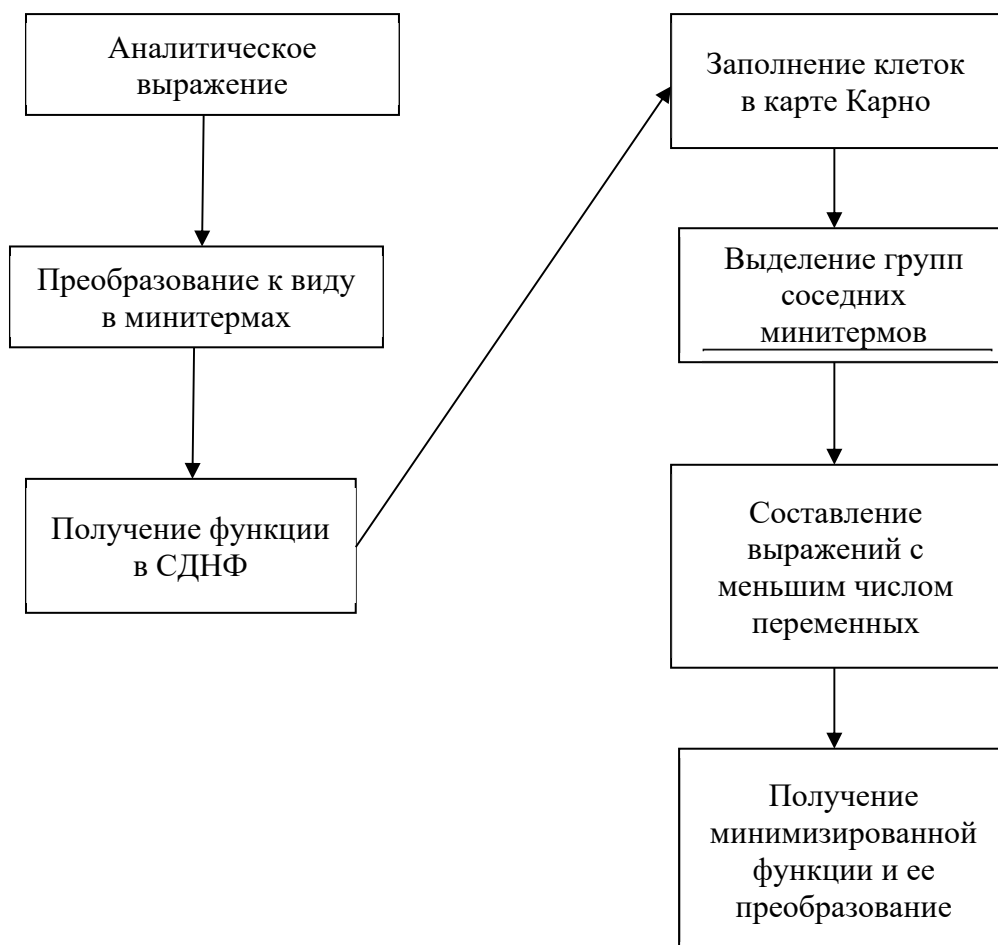
Рис. 7. Блок-схема алгоритма минимизации логической функции
