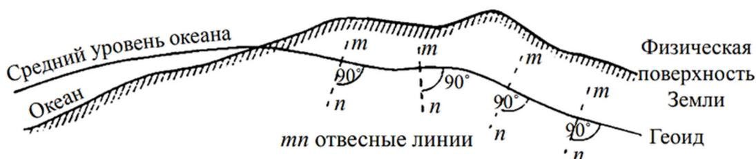
Рис. 2.6. Геоид и физическая поверхность Земли [4]
