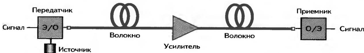
Рис. 3.1. Принципиальная схема оптической волоконной связи
