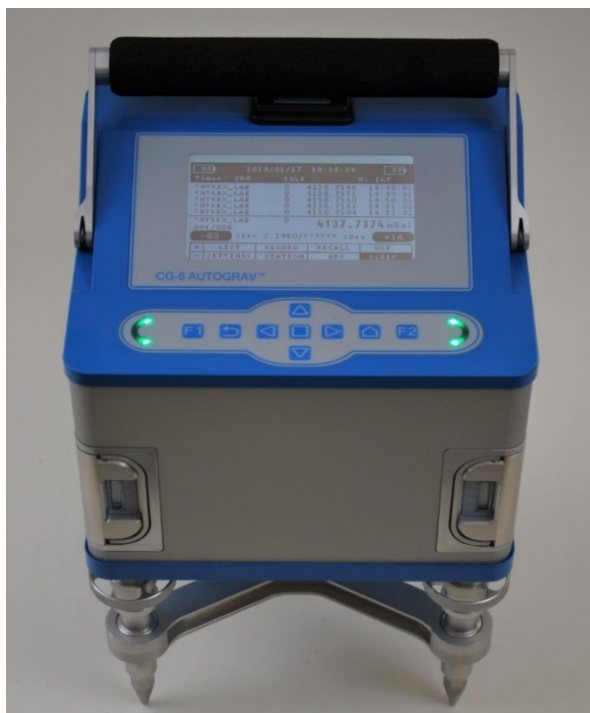
Рис. 1.4. Цифровой гравиметр CG-6 AUTOGRAV
