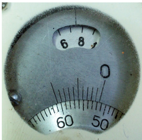
Рис. 1.12. Отсчетное устройство гравиметра ГНУ-КВ. Отсчет в оборотах равен 7,516
