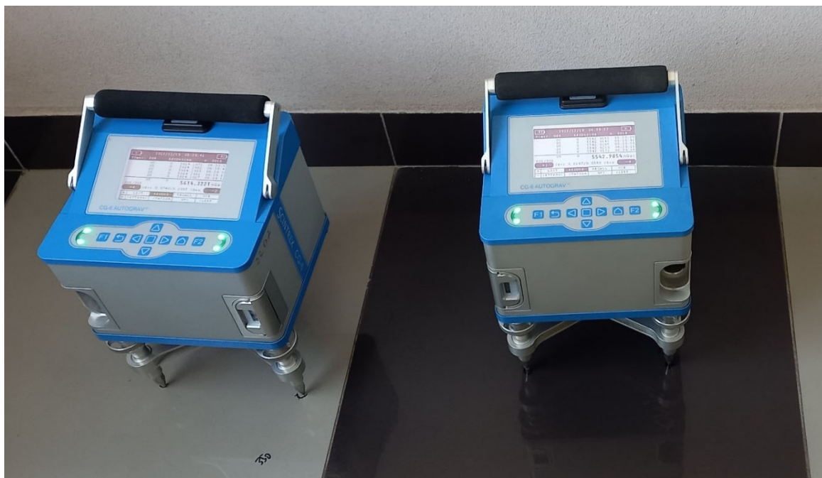
Рис. 1.17. Установка гравиметра в горизонтальное положение по цифровым показаниям уровня, отображаемым в арксекундах, и стрелкам выравнивания
