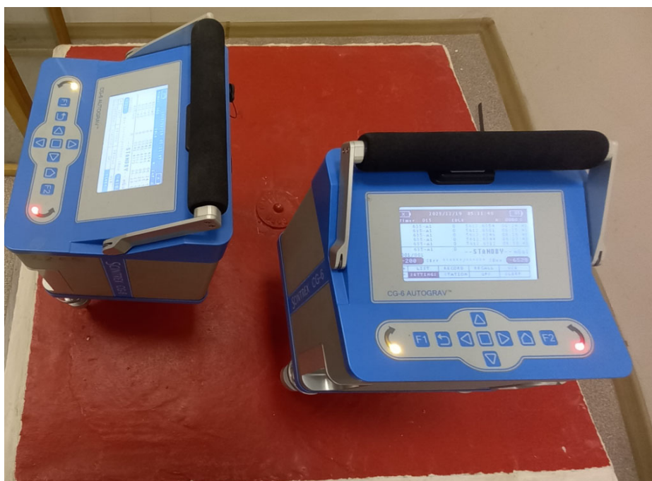
Рис. 1.16. Установка гравиметров на исходном пункте
