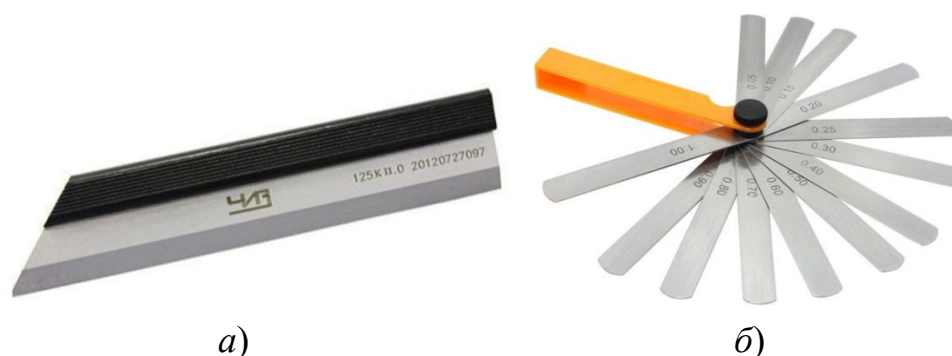
Рис. 2. Образцовые средства для определения неплоскостности верхней плоскости головки штатива:
