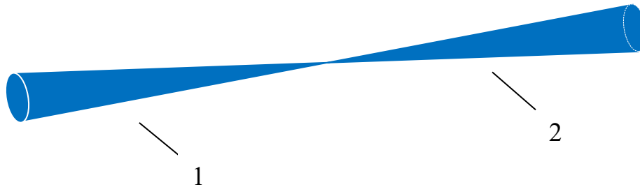
Рис. 1.1. Пучки лучей: 1 – сходящийся гомоцентрический; 2 – расходящийся гомоцентрический
