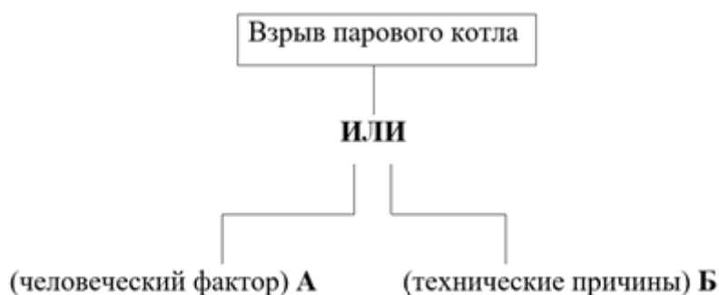
Рис. 2. Схема реализации логической операции ИЛИ
