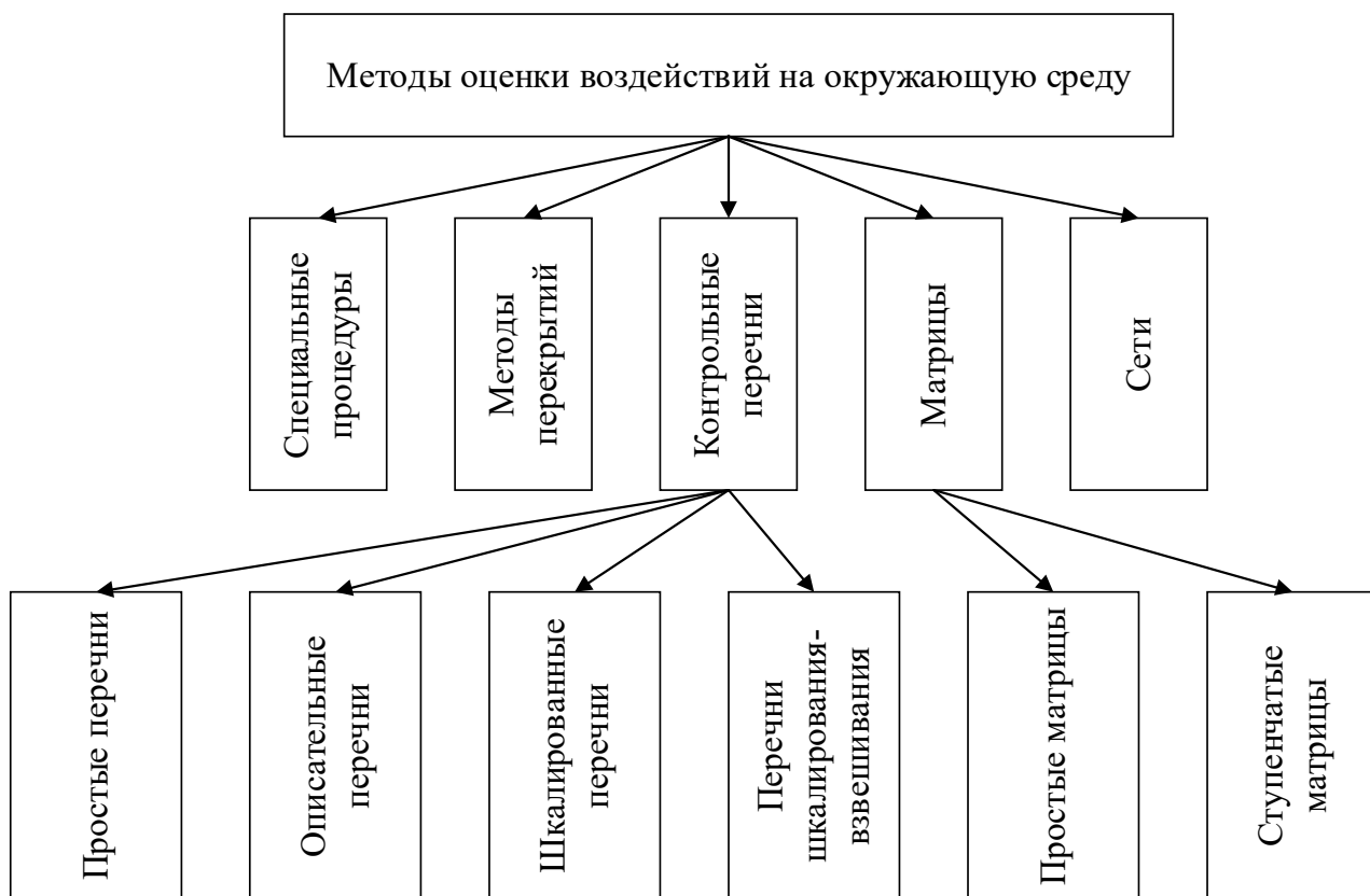
Рис. 2. Классификация методов оценки воздействий на окружающую среду
