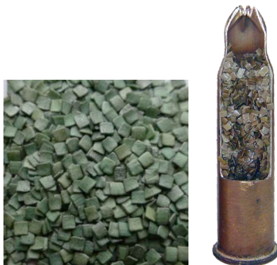
Рис. 53. Зерна пороха Х (Пл 10-12) (слева); холостой патрон 7,62×54 мм в разрезе с порохом Х (Пл 10-12) (справа)
