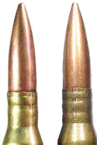
Рис. 22. Крепление пули двойным/тройным обжимом дульца
