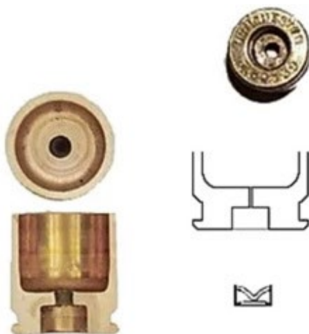
Рис. 65. Гильза для капсюля-воспламенителя с наковальней
