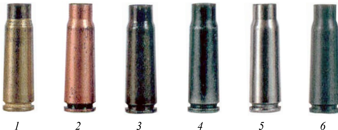
Рис. 12. Гильзы патронов калибра 7,62 мм образца 1943 г. 7,62×39 мм: 1 – ГЖ (сталь плакированная латунью); 2 – ГЖ (сталь плакированная томпаком); 3 – ГС (сталь лакированная); 4 – опытная алюминиевая; 5 – стальная никелированная (коммерческая); 6 – стальная с полимерным покрытием
