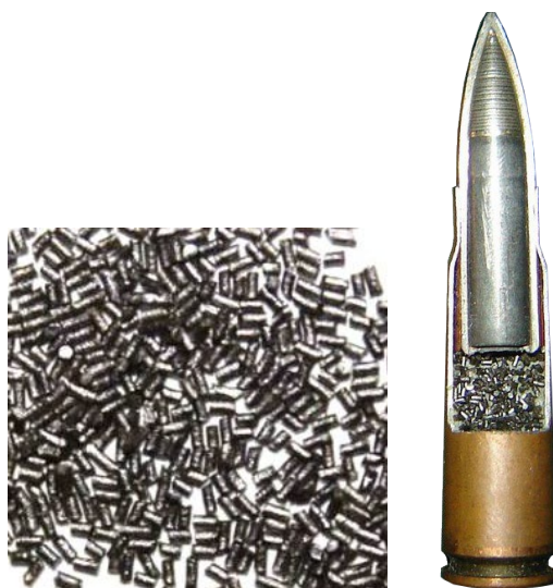
Рис. 55. Зерна пороха ВУфл (слева); патрон 7,62×39 мм в разрезе с порохом ВУфл (справа)
