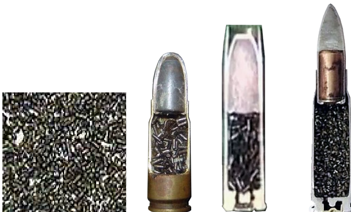
Рис. 51. Зерна пороха П-45/1; патроны в разрезе с порохом П-45 (слева направо): 7,62×25 мм; 7,62×38 мм; 7,62×39 мм
