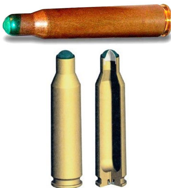
Рис. 9. Деталь конструкции холостого патрона
