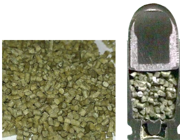
Рис. 52. Зерна пороха П-125 (слева); патрон 9×18 мм в разрезе с порохом П-125 (справа)
