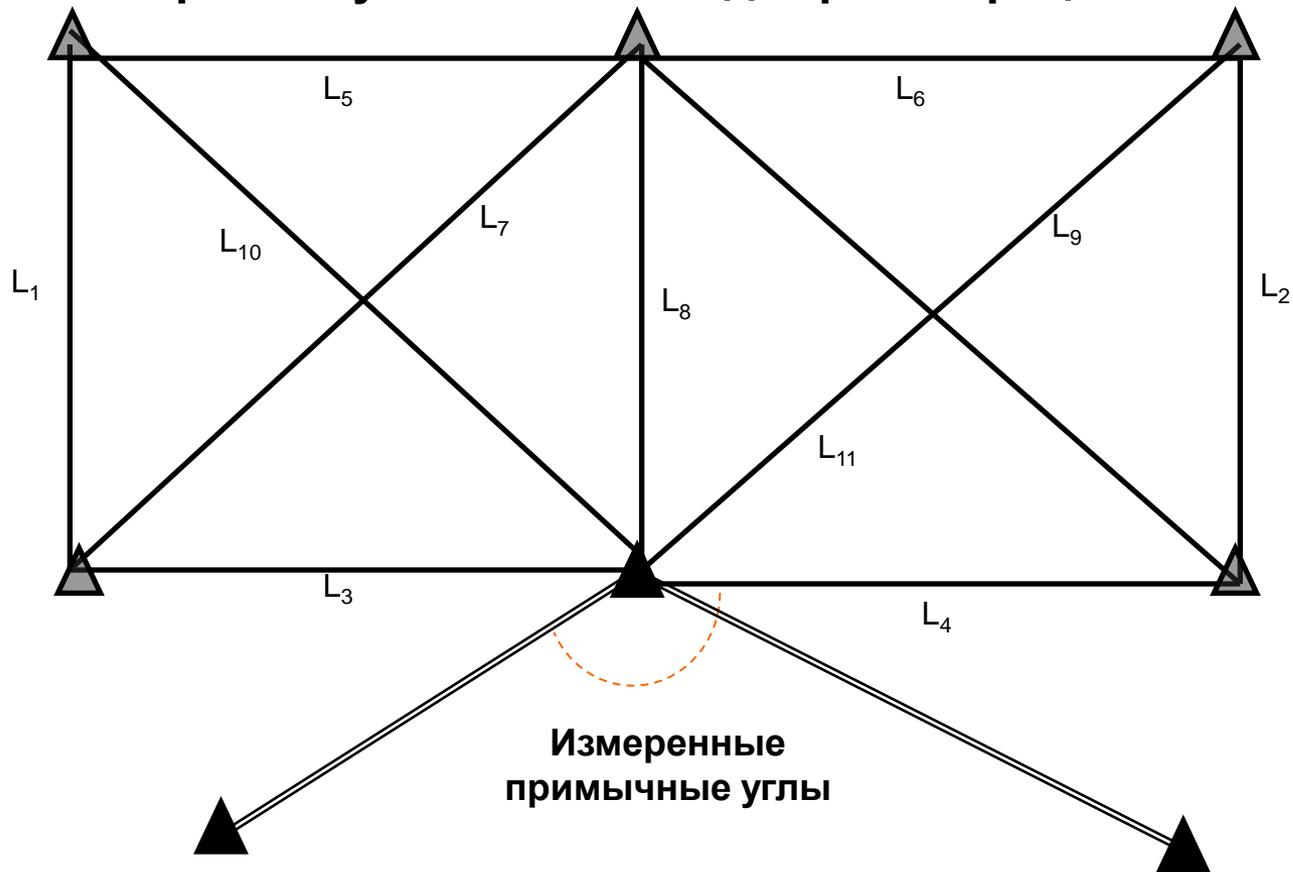
*Трилатерация - сеть из треугольников или геодезических четырёхугольников, в которых измерены длины линий и для ориентирования сети примычные углы между исходными дирекционными углами и сторонами сети.*
