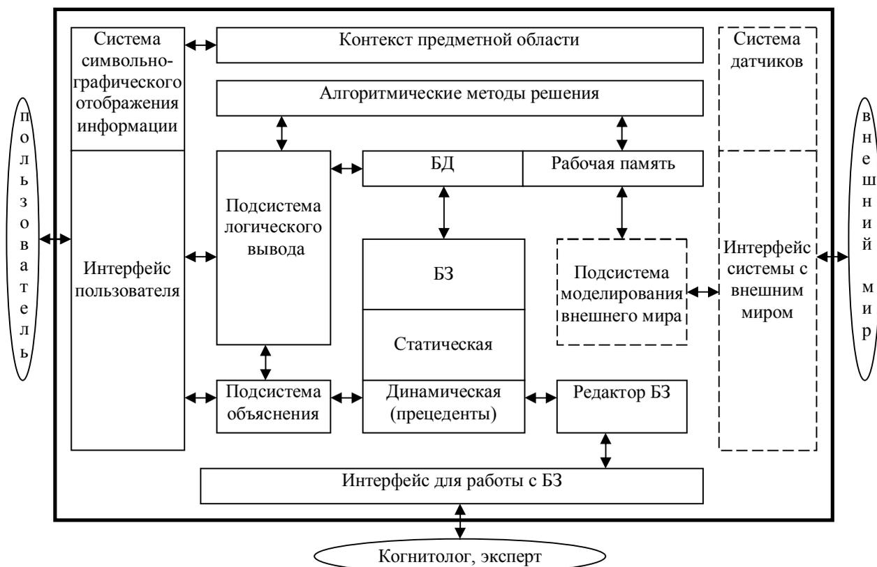
**Рис. 31. Структура экспертной системы**
