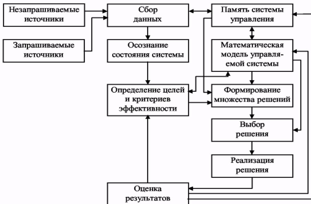
**Рис. 37. Процессы системы поддержки принятия решений**
