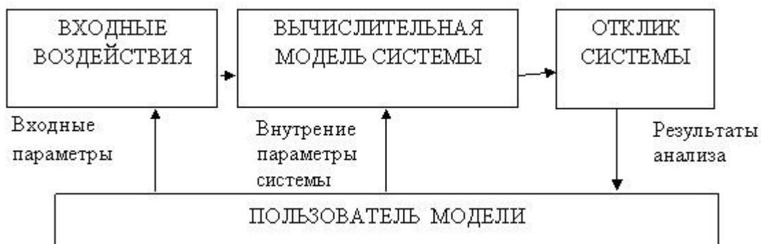
Рис.2.4. Процесс анализа системы с помощью вычислительной модели
