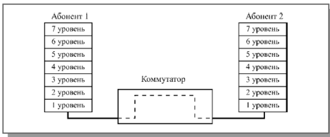
Рис. 5.10. Функции коммутаторов в модели OSI
