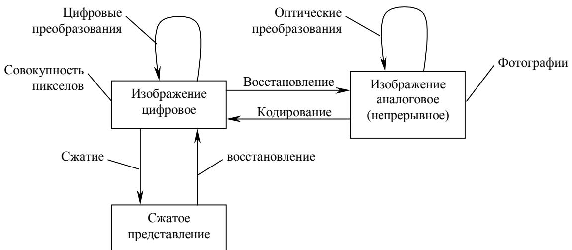
Рисунок 1 – Задачи обработки изображения
