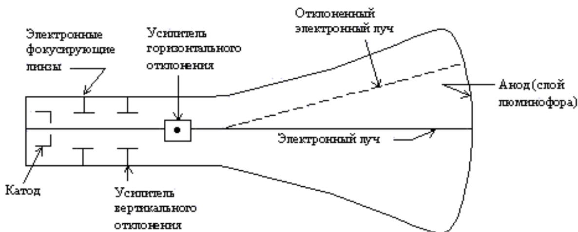
Рисунок 25 – Электронно-лучевая трубка
