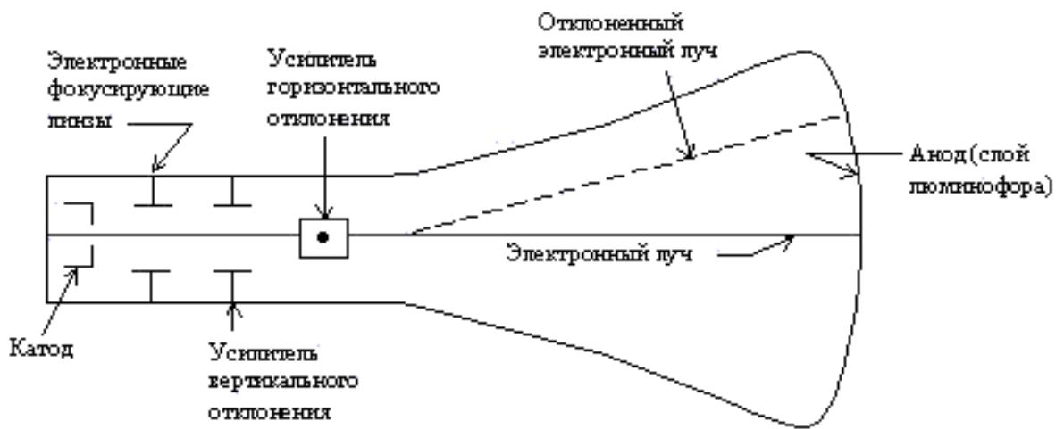
Рисунок 25 – Электронно-лучевая трубка
