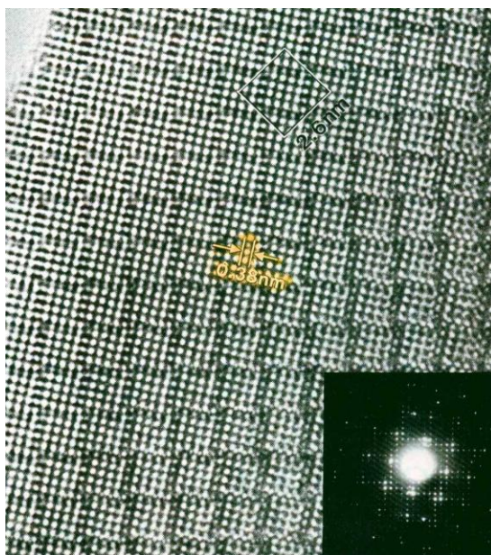
Рис. 4. Двумерное электронное изображение кристалла Nb, полученное при 200 кэВ ускоряющего напряжения и увеличении в 6.000.000 раз. Черные точки соответствуют позициям атомов Nb, белые – каналам межатомного пространства
