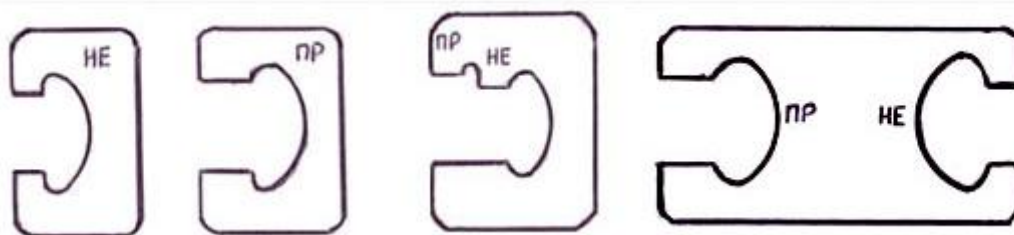
Рис. 2. Общий вид однопредельных калибров (а), двухпредельного одностороннего калибра (б) и двухпредельного двустороннего калибра (в)
