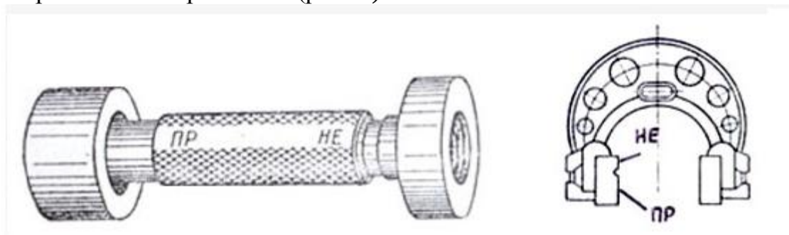
Рис. 4. Примеры предельных калибров с разной длиной проходной и непроходной сторон
