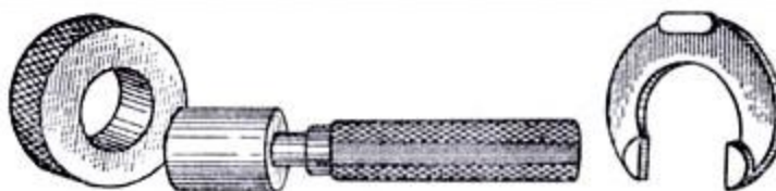
Рис. 1. Общий вид нормальных калибров: кольца (а), пробки (б) и скобы (в)
