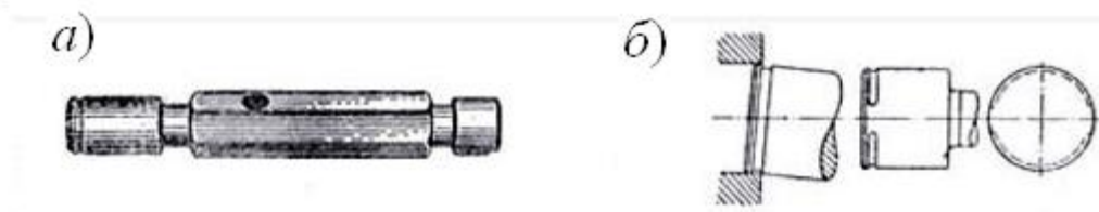
Рис. 14. Общий вид пробки с направляющим пояском (а) и схема контроля (б)
