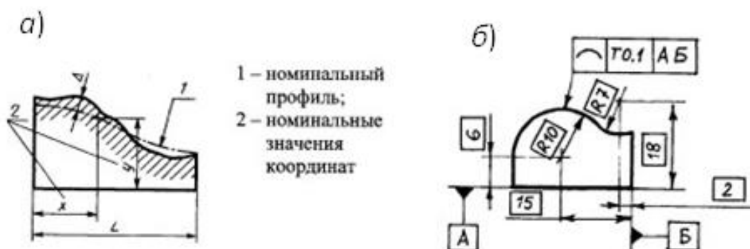
Рис. 28. Эскиз отклонения формы заданного профиля и пример обозначения на чертеже
