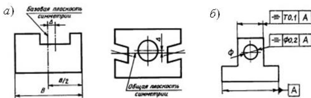
Рис. 7. Эскизы отклонения от симметричности (а) и примеры обозначений на чертеже (б)
