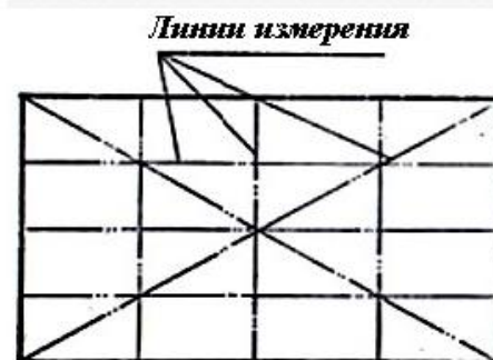
Рис. 9. Линии измерения лекальной линейкой отклонения от плоскостности
