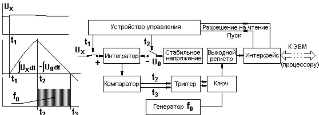
Рис. 50. К принципу действия интегрирующего АЦП
